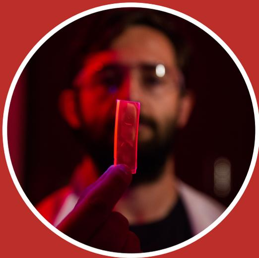
L'invenzione si riferisce ad un dispositivo e metodo di realizzazione di concentratori solari luminescenti basati su nanostrutture di silicio. Tale dispositivo, capace di convertire l'energia solare, è in grado di generare corrente da un pannello polimerico trasparente contenente nanostrutture di silicio luminescenti nel rosso o vicino infrarosso (NIR).
