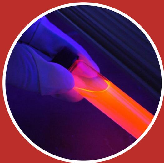
L'invenzione riguarda una nuova famiglia di particelle di silice che, drogate con luminofori, presentano un segnale elettrochemiluminescente notevolmente più stabile rispetto ad altri sistemi commerciali comunemente utilizzati.
