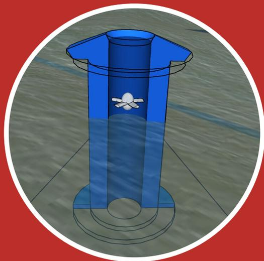
L'invenzione consiste in un dispositivo di conversione dell'energia che viene prodotta dal moto ondoso. Il sistema è in grado infatti di produrre energia sfruttando il movimento relativo tra la struttura galleggiante e la colonna d'acqua interna.
